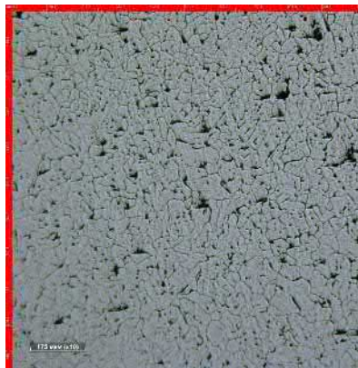
Рис. 5. Микроструктура слитка системы \text{Zr-Y} , полученная методом ВДГПНЭ
